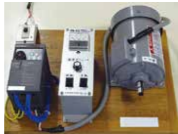
インバータ可変連運転実習
