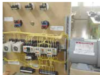
電動機とシーケンス制御回路
