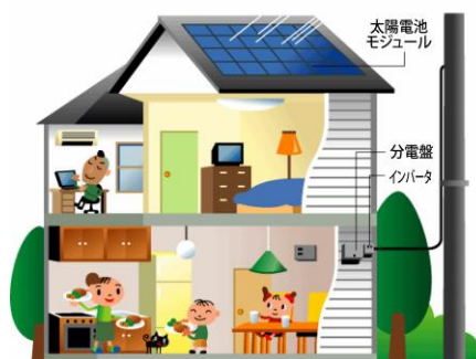
図 3-2 太陽光発電利用システム
