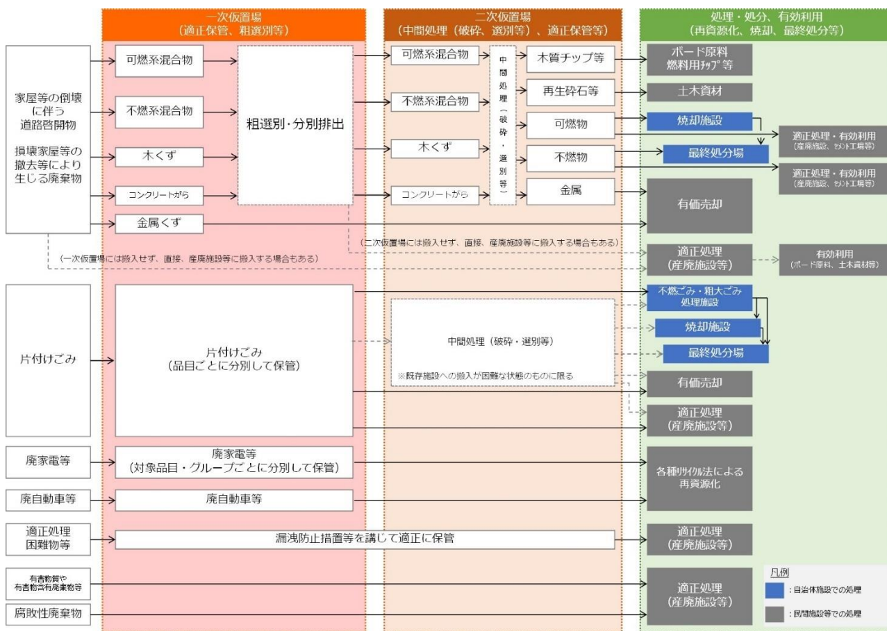
図表6-8 災害廃棄物の概略処理フロー（二次仮置場を設置する場合）
