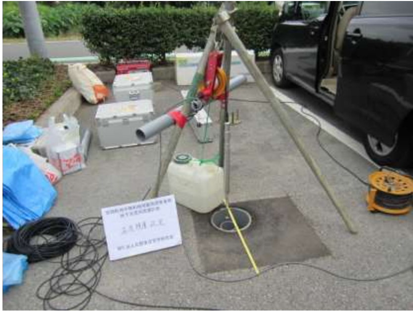
図 36 流向流速計測状況
